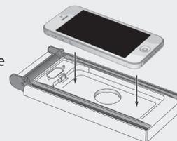
3. Prenez ensuite le film à la main (film pour écran collé au film de protection, et supports). Séparez légèrement le film de protection du film pour écran en courbant le plus large des deux supports en plastique légèrement vers le bas, afin de le détacher.
