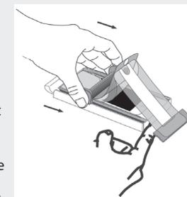
6. Après avoir déroulé complètement le film de protection sur l'écran, faites glisser le rouleau de manière à le replacer dans son support. Détachez alors avec précaution le cache foncé qui est encore collé sur le film pour écran, à l'extrémité d'un coin inférieur. Ce faisant, veillez à ne pas décoller le film pour écran.
