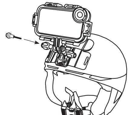
Glissez maintenant le clip de fixation dans le rail de l'adaptateur pour casque. La coque dans laquelle est inséré l'appareil peut être orientée de haut en bas à 180°.
