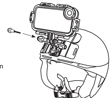
Schieben Sie nun den Befestigungsclip in die dafür vorgesehene Schiene der Helm-Adapterplatte. Richten Sie das Gehäuse mit der eingelegten Kamera im gewünschten vertikalen Winkel aus. Sie können die Kamera vertikal um 180° schwenken.
